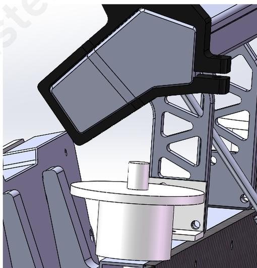
图表 7 灯条模块与快拆插销干涉示意图
